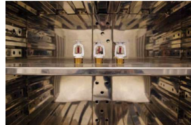
آزمون‌های مقاومت به دمای بالا مطابق استاندارد EN 12259
