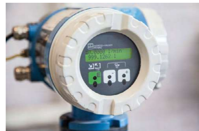
دبی سنجی تعیین ضریب K-factor مطابق با استانداردهای EN 12259 و UL 199
